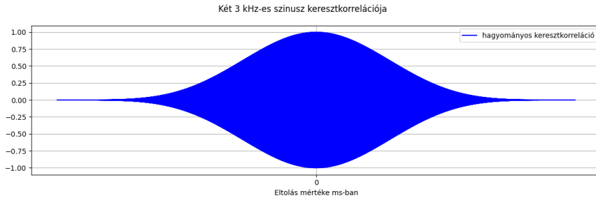
39. ábra: két 3 KHz-es jel keresztkorrelációja
