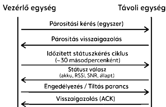
13. ábra A végleges eszköz kommunikációs folyamata
