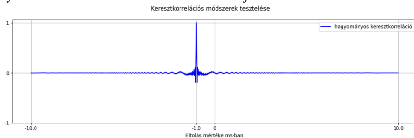
38. ábra: sweep jel keresztkorrelációs függvénye
