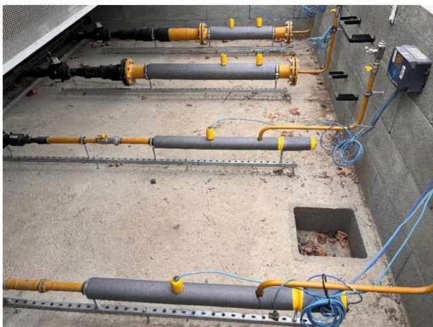
27. ábra: Gázhálózati kötések vizsgálata (OPUS Tigáz Zrt.) [42].
